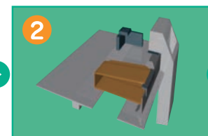
2 自动弯折涂抹浆糊的部分。弯曲剩余 纸板, 将箱子插入到挡块处, 踩下脚 踏开关, 开始缝合。
