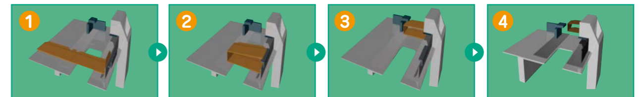
1 左から滑らすようにシートを供給し半自動でシートが立ち上がってきます。 2 自動でのり代は折られます。残りのシートを曲げて、ケースをストッパーまで押し込んでフットスイッチを踏んで縫合スタートです。 3 総合距離はカウンターで設定します。 4 自動で糸切が動き、縫い終わります。
